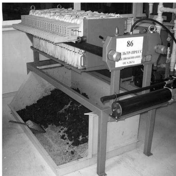
Рис. 4. Фильтр-пресс Regada на промышленных очистных сооружениях ОАО «Северный пресс», Санкт-Петербург
