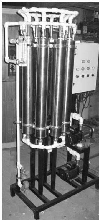
Рис. 3. Установка ультрафильтрации с керамическими мембранами производительностью до 3 м<sup>3</sup>/ч
