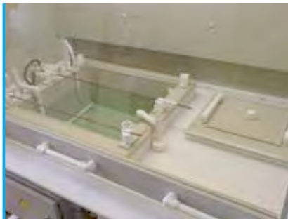
Ванна палладирования с непрямым нагревом и ванна улавливания установки нанесения покрытия палладий никель
