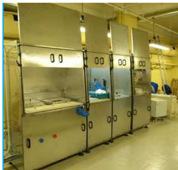
Комплекс оборудования для горячего лужения мелких деталей в тиглях и центрифуге
