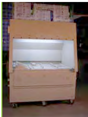
Установка травления алюминия общий вид
