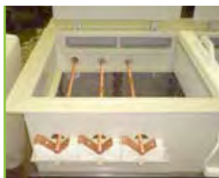
Узел проработки хромового электролита
