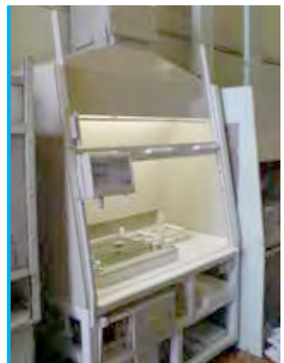
Установка нанесения покрытия палладий-никель
