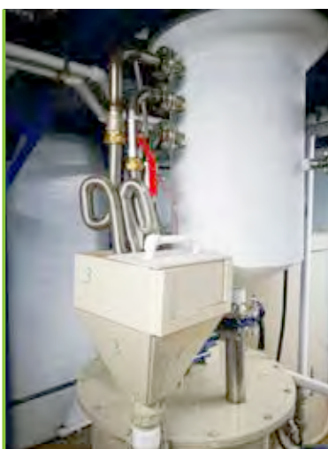
Переливной узел установки УТК-ПГ-500М
