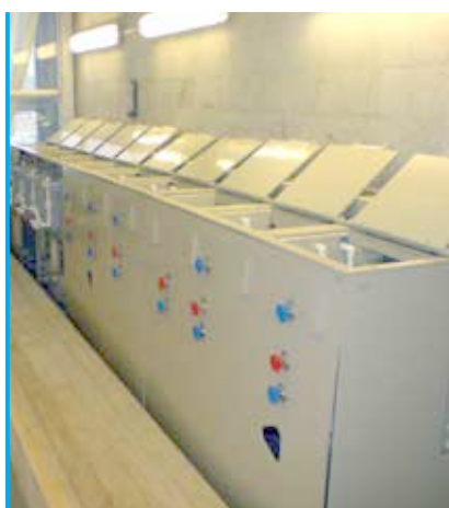
Гальваническая линия нанесения покрытий из меди и никеля на детали из титана и его сплавов с предварительной гидридной обработкой
