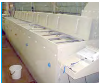
Гальваническая линия нанесения покрытий из меди и никеля на детали из титана и его сплавов с предварительной гидридной обработкой
